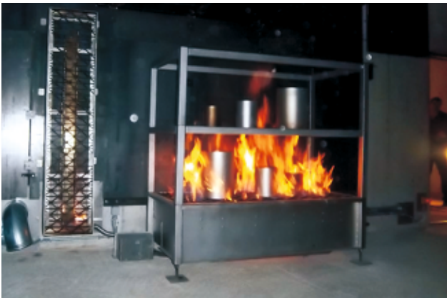
Feu d'étagère à côté de point de feu de gaine électrique inactive
