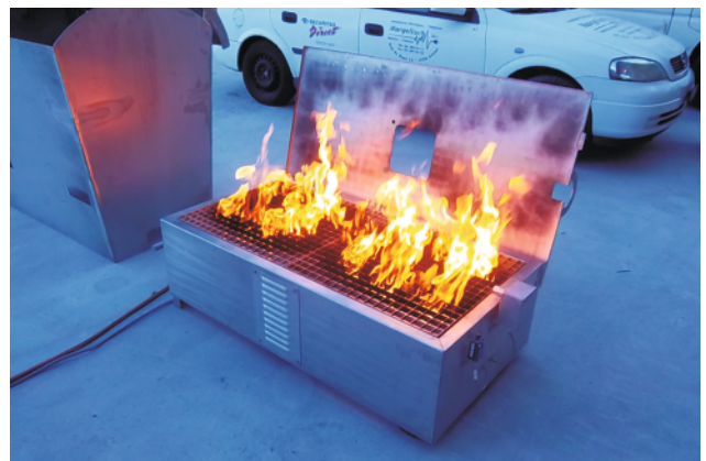
Simulateur portatif pour entraînement avec extincteurs P-250
