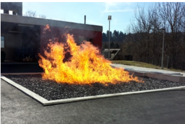
50 m² Fuel Spill (O-250)
