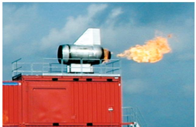
*Hecktriebwerksbrand (Modul D)*
